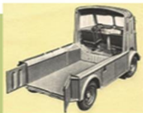
▲ Le Type H est véritablement un véhicule pratique et malin : un espace de rangement sert aussi de tiroir-caisse et la roue de secours est intégrée dans un espace latéral facilement accessible pour ne pas empiéter sur le volume de chargement. À droite, la version châssis plateau qui pouvait accommoder d'une multitude de carrosseries.
