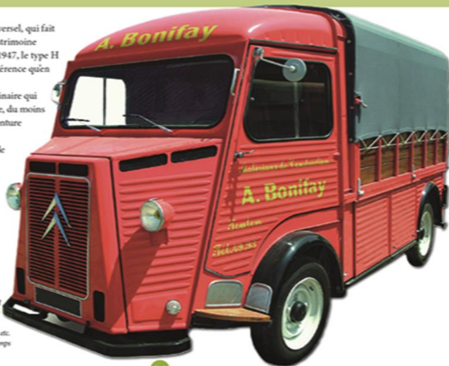
▲ Le Type H est véritablement un véhicule pratique et malin : un espace de rangement sert aussi de tiroir-caisse et la roue de secours est intégrée dans un espace latéral facilement accessible pour ne pas empiéter sur le volume de chargement. À droite, la version châssis plateau qui pouvait accommoder d'une multitude de carrosseries.
