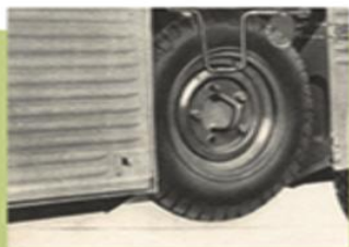
▲ Le Type H est véritablement un véhicule pratique et malin : un espace de rangement sert aussi de tiroir-caisse et la roue de secours est intégrée dans un espace latéral facilement accessible pour ne pas empiéter sur le volume de chargement. À droite, la version châssis plateau qui pouvait accommoder d'une multitude de carrosseries.
