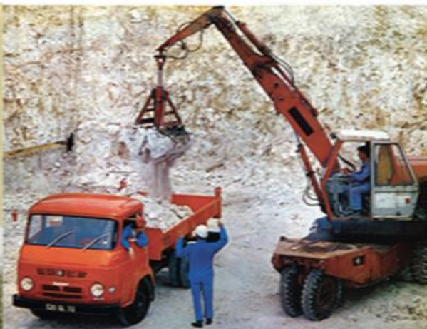
▲ Un Renault Super Galion SGA de première génération carrossé en benne en cours de chargement par une pelle Peclain TY 45, marque française spécialisée dans la pelle hydraulique et qui va connaître un prodigieux essor pendant les Trente-Glorieuses.
